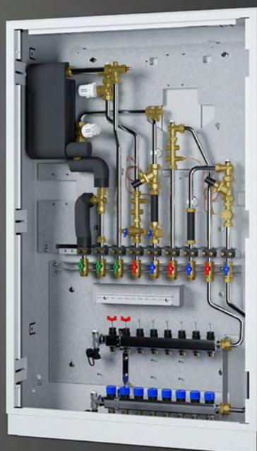
Questa stazione di distribuzione è multitasking: si utilizza specificamente per l'installazione in un sistema a 4 linee. A tale scopo è integrato un circuito di riscaldamento a bassa temperatura non miscelato. L'apparecchio lavora con un sistema a due serbatoi: la produzione di acqua calda sanitaria avviene ad una temperatura elevata, l'alimentazione del riscaldamento a pavimento ad una temperatura più bassa.
