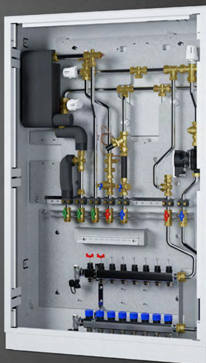
Nel funzionamento questa stazione di distribuzione si dimostra versatile. L'apparecchio viene utilizzato non solo per fornire acqua calda sanitaria, ma anche per il riscaldamento. Quest'ultimo è reso possibile da un circuito di riscaldamento miscelato con regolazione termostatica.
